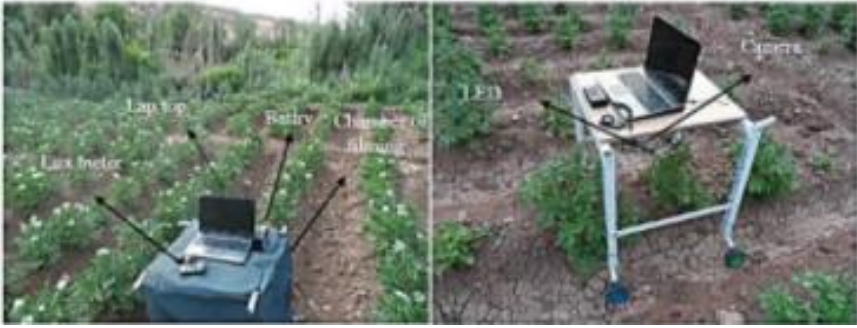
Şekil 7. İki Farklı Görüntü Elde Etme Sistemi (Sabzi and Abbaspour-Gilandeh, 2018).
