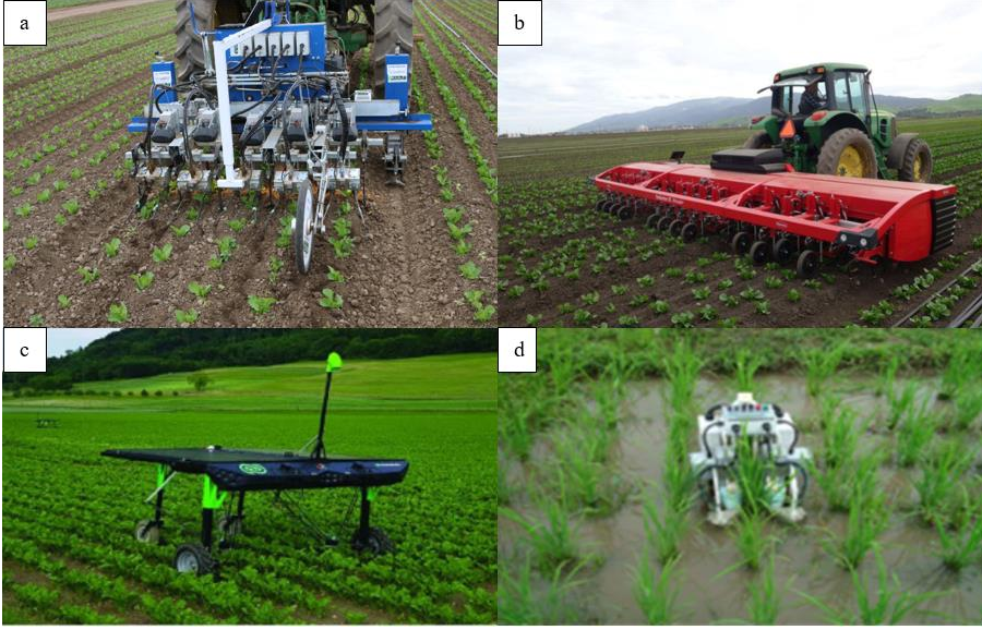
Şekil 1. Son yıllarda ticari olarak yabancı ot mücadelesinde kullanılan bazı robotik makineler: a. Robovator kültivatör (Fennimore ve Cutulle, 2019). b. Steketee IC (Peruzzi ve ark., 2017). c. EcoRobotix (Ben-Ari ve ark., 2018). d. Yabancı ot robotu (Sori ve ark., 2018).
