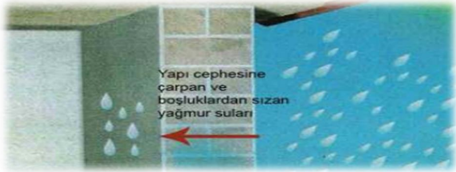
Şekil 1. Yağışların yapı cephesine etkisi (Dere, 2011)
