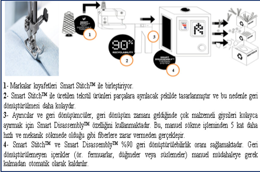
Şekil 11: Resortecs dikiş ipliği özellikleri (Resortecs, t.y.)
