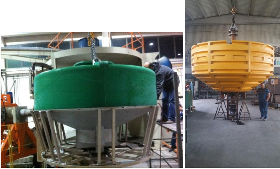
Şekil 9: Şamandıraların montaj ve kurulumu
