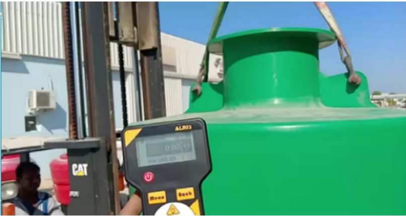
Şekil 10: Şamandıraların kurulumu ve testi
