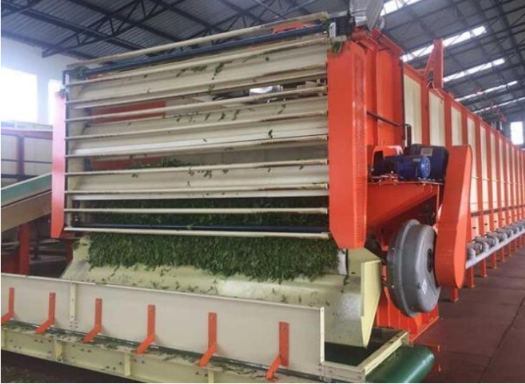
Şekil 35. Yaş Yaprak Depolama Ünitesi (Kaynak: Orijinal Fotoğraf, Ş. ILGAZ )
