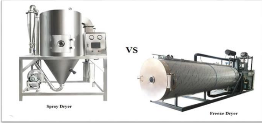
Şekil 106. Püskürtmeli Kurutucu ve Dondurarak Kurutma Cihazı (Kaynak: Aipak, 2024)
