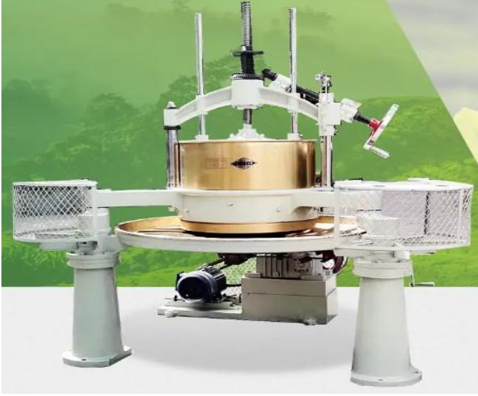
Şekil 38. Presli Kıvrırma (Kaynak: TERADA, 2024)
