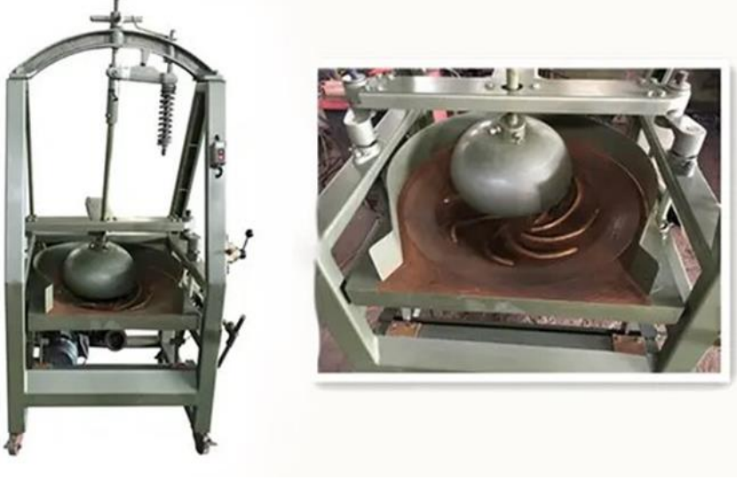
Şekil 67. Ay Tipi Mini Kıvrırma Makinası (a) ve Kıvrırma Tablası (b) (Kaynak: Orijinal Fotoğraf, Ş. ILGAZ)
