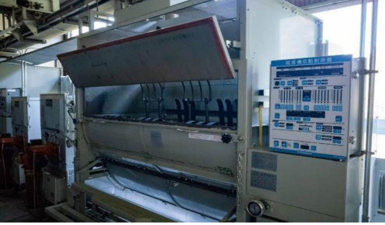
Şekil 37. I.Kıvırma-Kurutma Makinesi (Kaynak: Orijinal Fotoğraf, Ş. ILGAZ )
