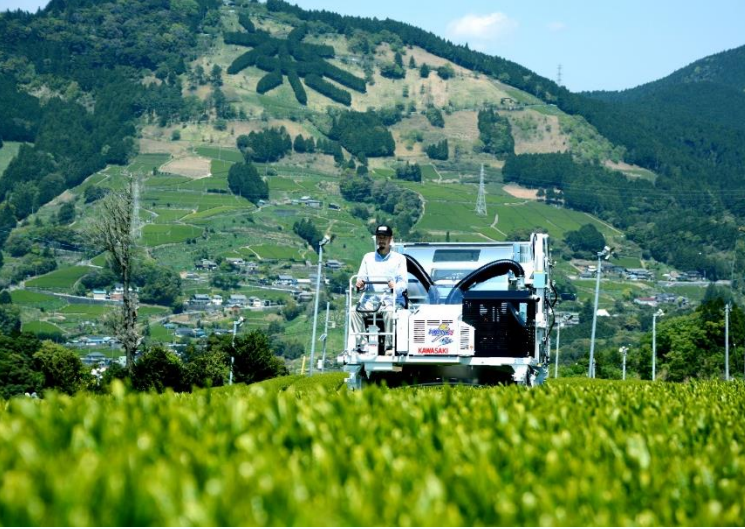
Şekil 32. Japonya'da kullanılan traktör tip çay hasat makineleri Kaynak: Orijinal fotoğraf, Y. NAKAMURA
