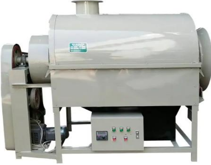
Şekil 31. Döner Kurutucu (Kaynak : CHAMA, 2024)
