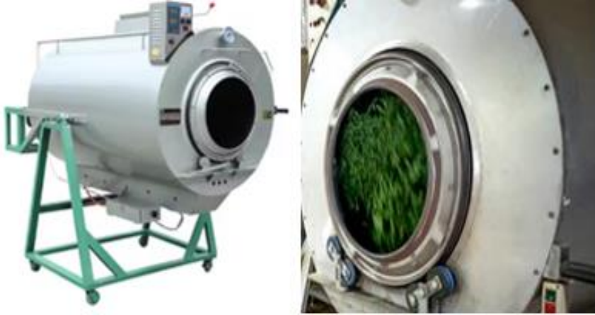
Şekil 29. Kuru Sıcak Hava ile Şoklama (pan-firing) İşlemi ( Kaynak: Orijinal Fotoğraf, Ş. ILGAZ)
