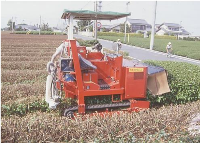
Şekil 27. Japonya'da traktör tipi budama makineleri Kaynak: Orijinal fotoğraf, Y. NAKAMURA
