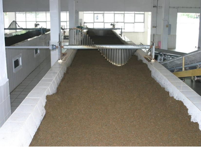
Şekil 9. Oksidasyon Ünitesi (Kaynak : ÇAYKUR, 2020)
