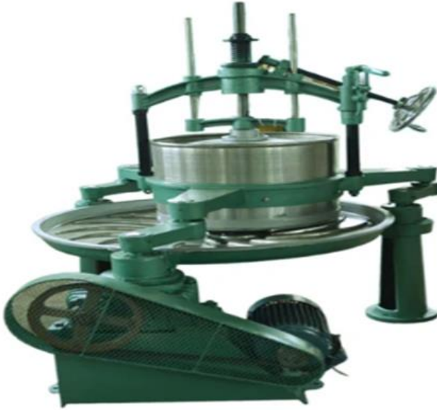
Şekil 30. Küçük Kapasiteli Presli Kıvrırma Makinesi (Kaynak: Xiamen Kuntuo, 2024)
