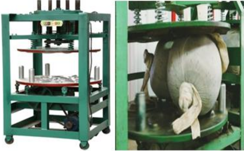
Şekil 68. .Bilyeli Kıvrırma Makinası (a), Bohçalı Kıvrırma İşlemi (b) (Kaynak: Orijinal Fotoğraf, Ş. ILGAZ)
