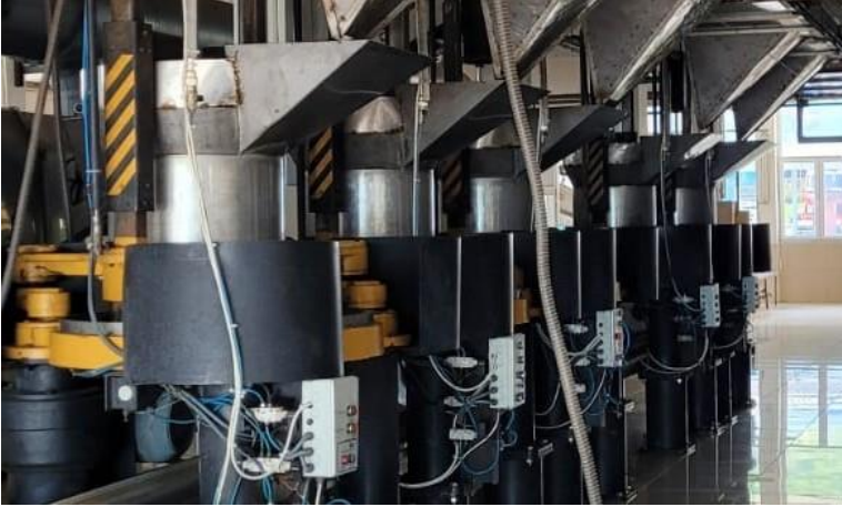
Şekil 46. Presli Kıvrırma Makineleri (Kaynak: ÇAYKUR, 2023)
