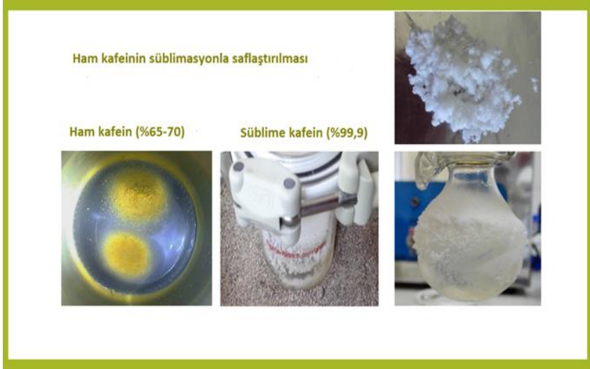
Şekil 97. Ham Kafeinin Süblimasyonla Saflaştırılması
