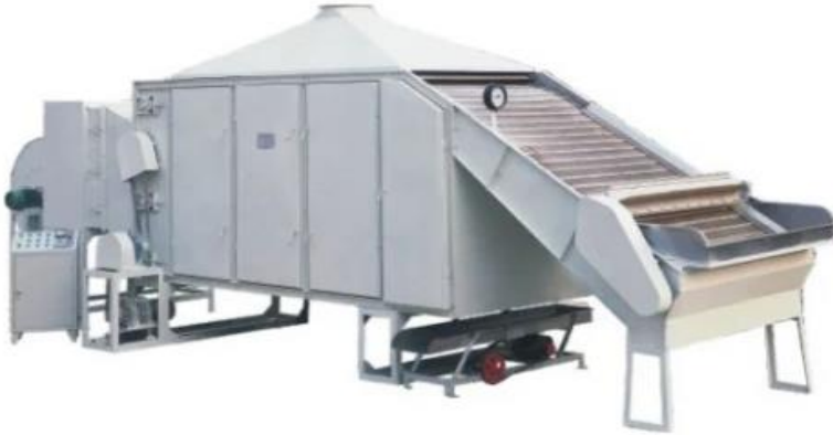
Şekil 41. ECP Kurutucu ( Kaynak: Hangzhou Jinzhu, 2024)
