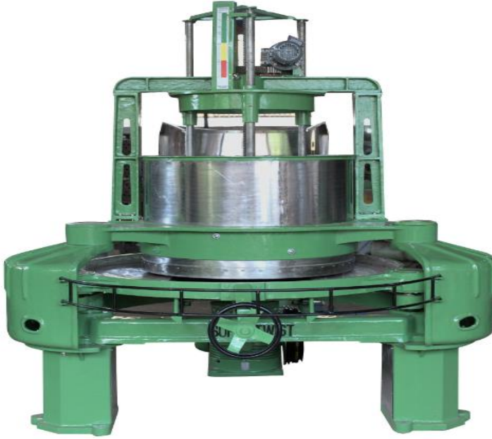
Şekil 6. Presli Kıvrırma Makinası ( Kaynak: Indiamart, 2024)
