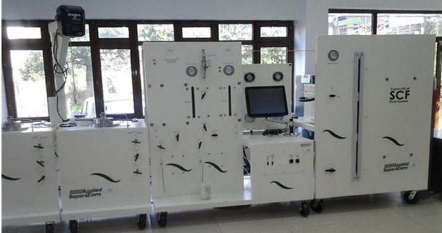
Şekil 94. Süperkritik CO 2 Ekstraktörü (Kaynak: Orijinal Fotoğraf, Ş. ILGAZ)
