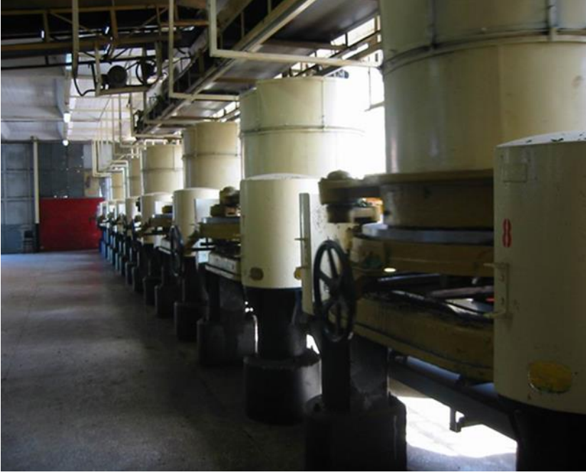
Şekil 5. Düz Kıvırma Makinaları (Kaynak: ÇAYKUR, 2020)
