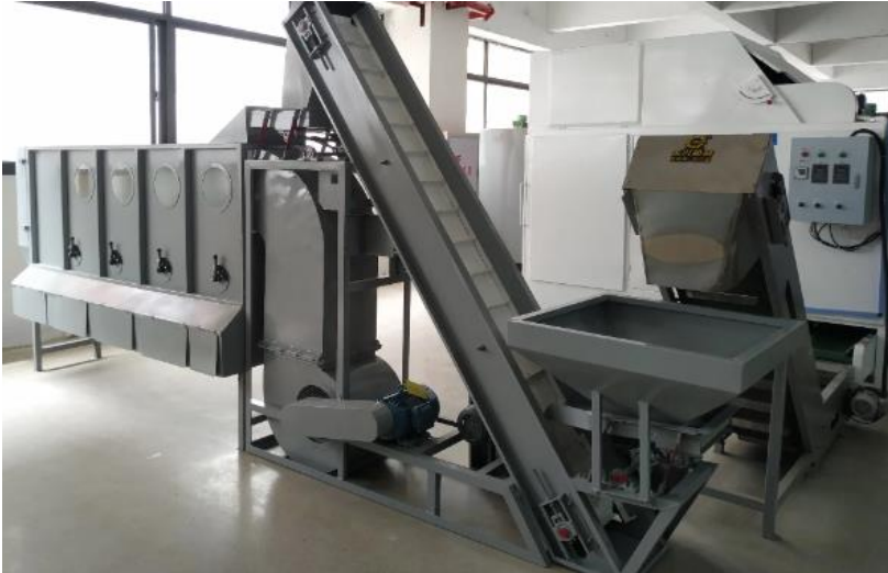
Şekil 34. Winnower Tasnif Sistemi (Kaynak: Orijinal Fotoğraf, Ş.ILGAZ)
