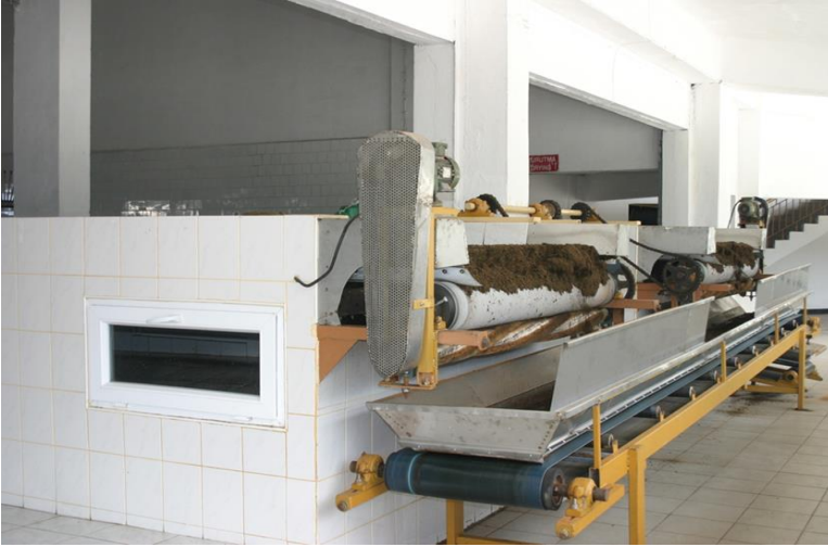
Şekil 10. Oksidasyon Çıkışı (Kaynak: ÇAYKUR, 2020)
