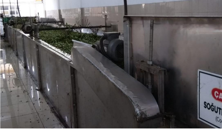
Şekil 44. Soğutma Ünitesi (Kaynak: ÇAYKUR, 2023)
