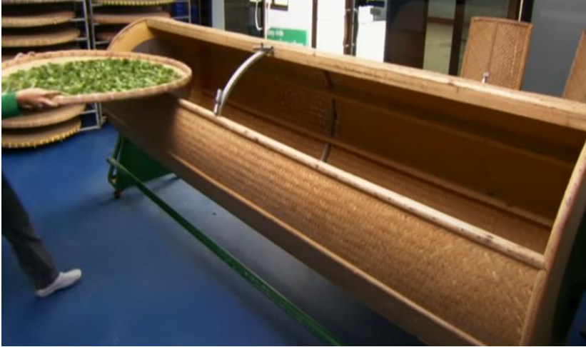
Şekil 65. Yaprak Bereleme Tamburu (Kaynak: Orijinal Fotoğraf, Ş.ILGAZ)
