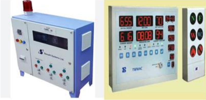
Şekil 4. Çayda Soldurma İzleme ve Kontrol Sistemi (TWMAC)
