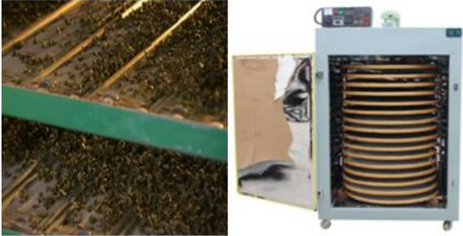
Şekil 69. ECP Tipi Kurutucuda İlk Kurutma (a), Tepsili Kurutucuda Son Kurutma (b) (Kaynak: Orijinal Fotoğraf, Ş. ILGAZ)
