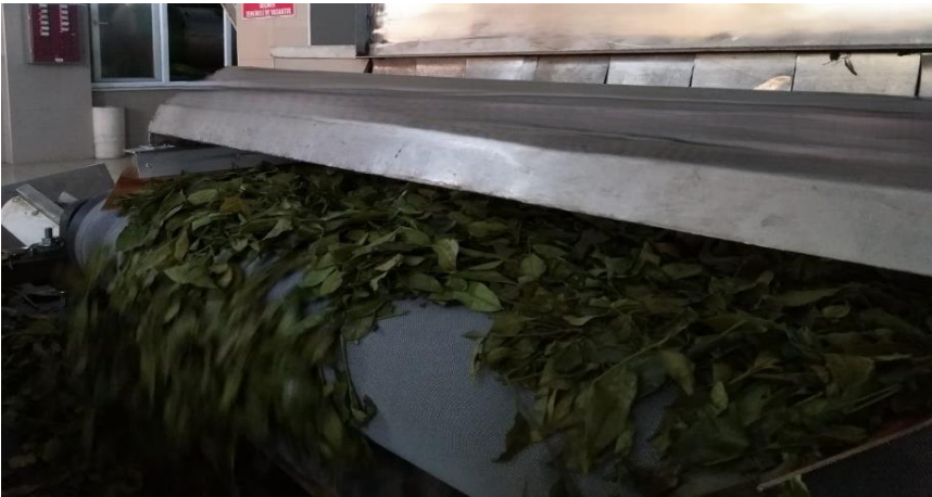
Şekil 45. Ön Kurutma Çıkışı (Kaynak: ÇAYKUR, 2023)
