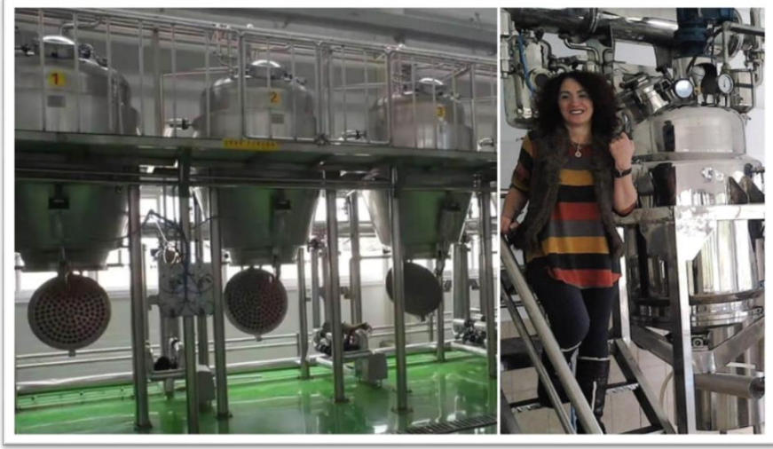
Şekil 101. Kesikli Ekstraksiyon Sistemi (Kaynak: Orijinal Fotoğraf, Ş. ILGAZ)
