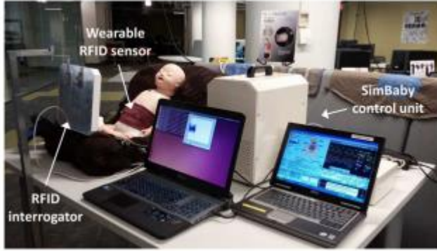
Şekil 31: Bebek Solunum İzleme için Deneysel Kurulum.
