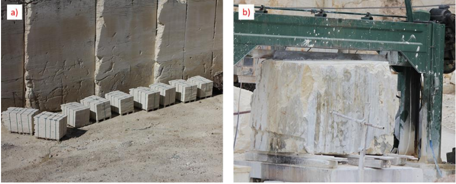
Resim 6. Küfeki taş ocağı aynası (a) ve kesim işlemi (b) (kufeki, 2024)
