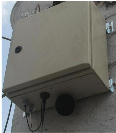
Şekil 2. Online gürültü izleme sistemi ölçüm istasyonu. (Şansal, 2010).
