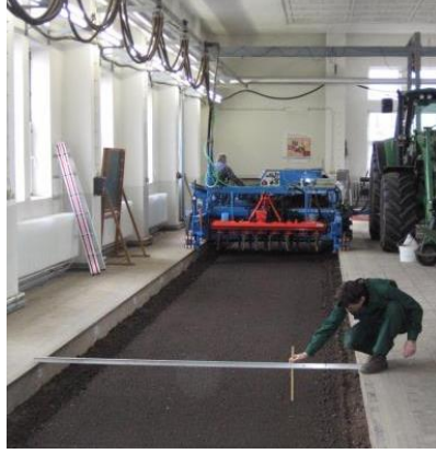
Şekil 3. Yer seviyesinde doğrusal toprak kanalı
