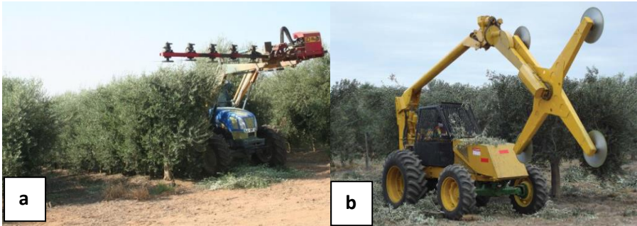
Şekil 36. Traktör üzerindeki mafsallı çubuğa monte edilmiş dairesel testereli budama makinesi (a) ve eklemli bir kola monte edilmiş dairesel testerelere sahip kendi kendine hareket eden budama makinesi (b) (Fabri, 2023).
