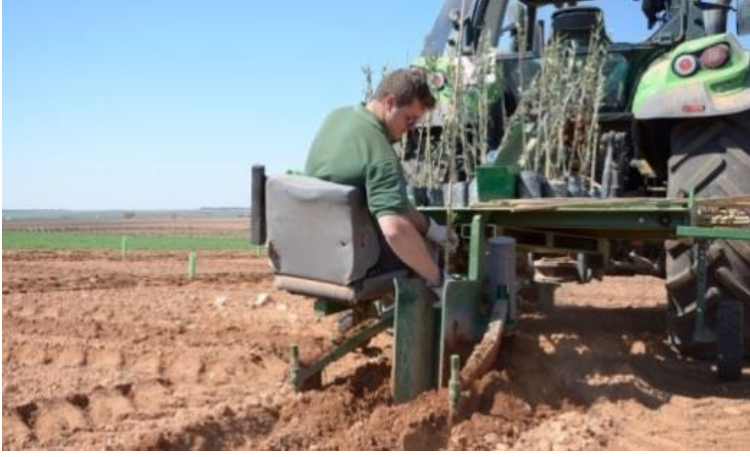
Şekil 4. Fidan dikim makinaları ile zeytin bahçesi tesisi.
