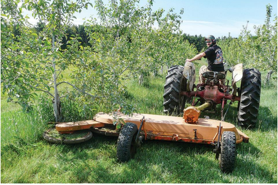
Şekil 3. Zeytin bahçesinde mekanik yabancı ot kontrolü (Bradshaw, 2019).
