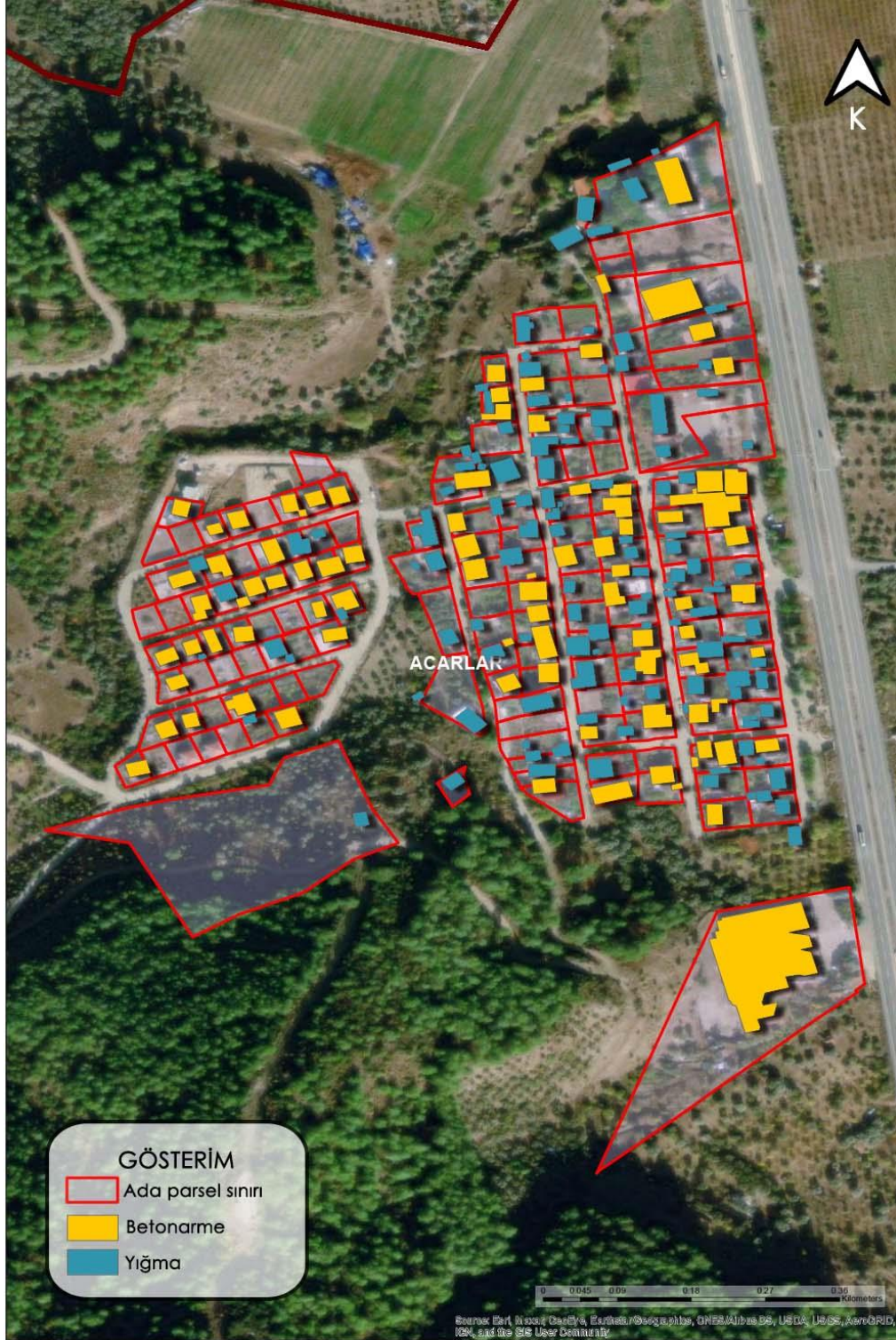
Şekil 88. Acarlar Mahallesi Betonarme/Yığma/Prefabrik Dağılımı
