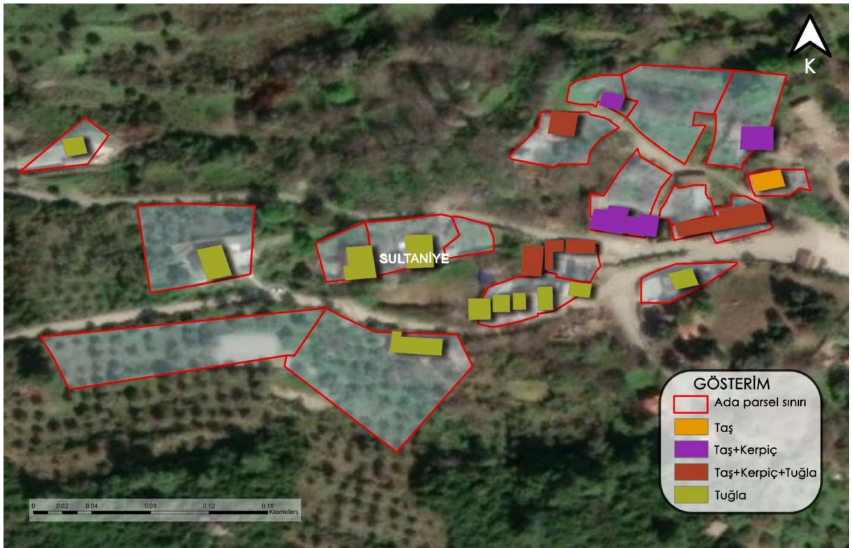
Şekil 113. Sultaniye Mahallesi Yapı Malzemesi
