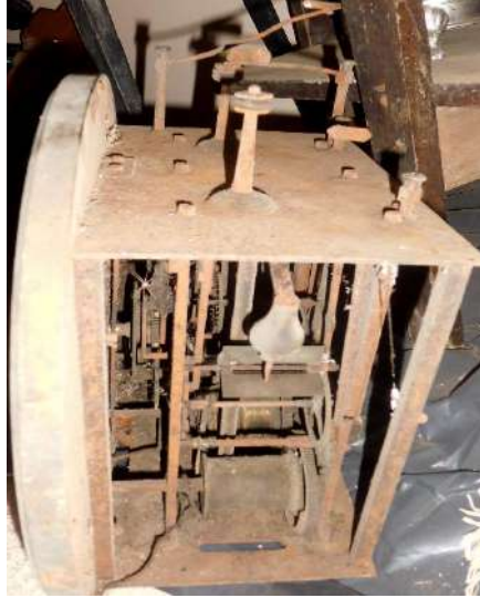
Fot.226, No-34, Üsküdar Valide-i Atik camisi saatin mekanik aksamı
