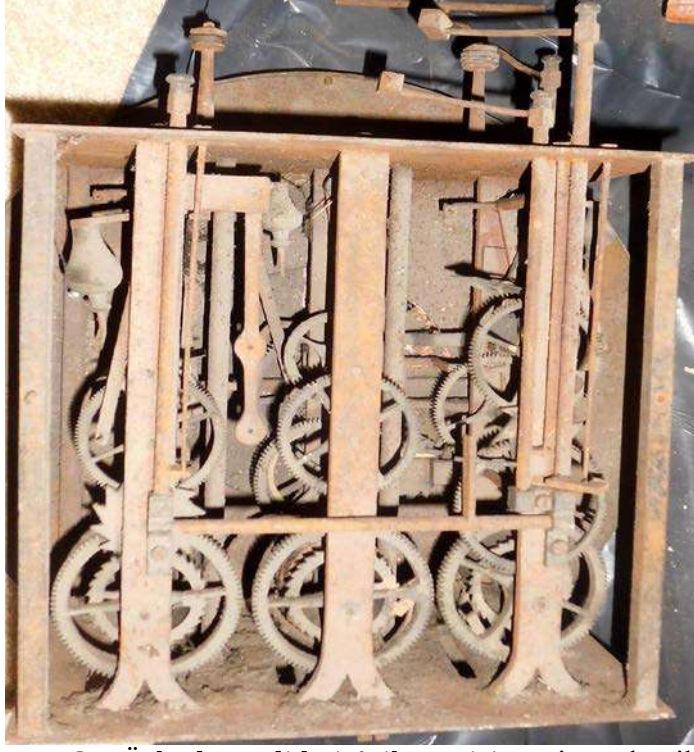
Fot.225, No-34, Üsküdar Valide-i Atik camisi saatin mekanik aksamı
