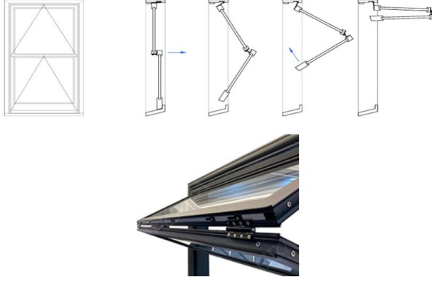
Görsel 222. Yatay ve Yukarı Katlanır Kanatlı Pencere Detayı (Why Foldup?, t.y.; High Quality Aluminum, t.y.).
