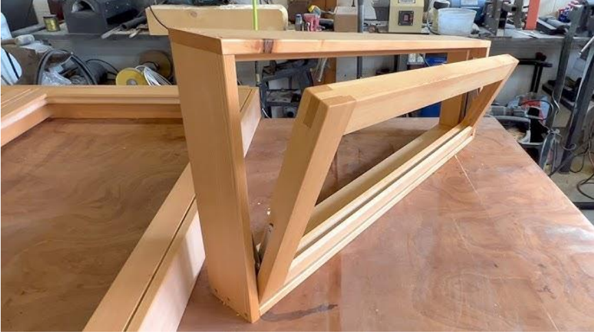
Görsel 292. Atölyede Masif Ahşap Pencere Doğrama Çerçevesi ve Köşe Birleşim Detayı (Wood Window Production, t.y.).
