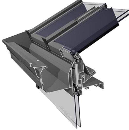
Görsel 334. Kış Bahçesi Çatı ve Düşey Eleman Arakesitinde Yağmur Oluğu (Winter Gardens, t.y.).
