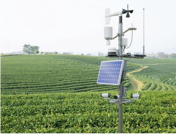
Şekil 10. Tarımsal alanlarda sıcaklık, nem, rüzgâr hızı ve yağış miktarını ölçmek için kullanılan sensörler ve güneş enerjisiyle çalışan otomatik meteoroloji istasyonu örneği.
