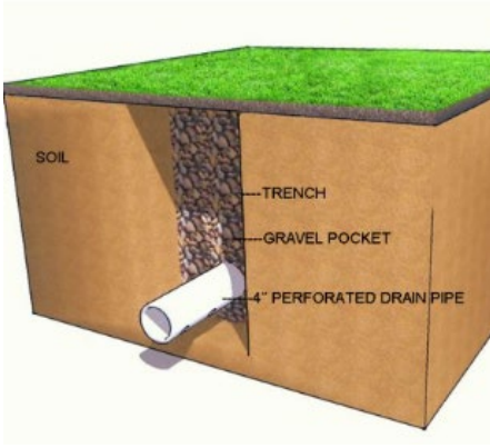
Şekil 2. Yeraltı drenaj sistemleri (Url-2, 2025).
