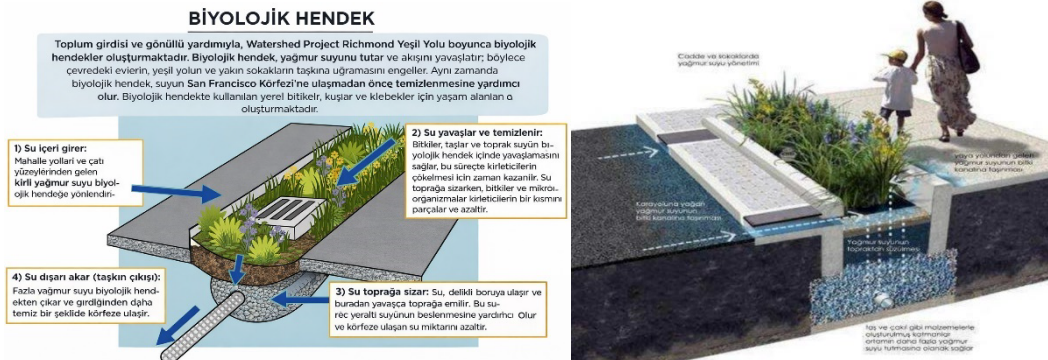
Şekil 4. Yağmur Bahçesi kesiti (Url-4, 2025).
