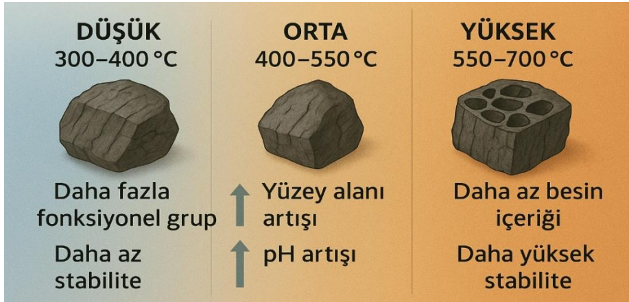
Şekil 2. Piroliz Sıcaklığının Biyokömür Özelliklerine Etkisi
