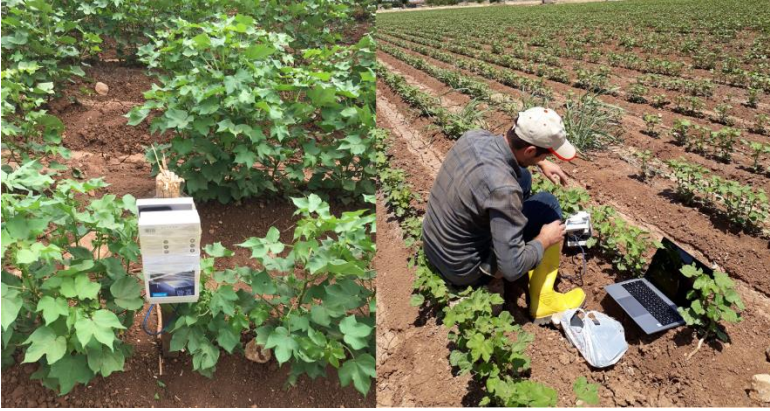
Şekil 2. Pamuk arazisine yerleştirilen nem sensörleri
