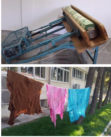
Şekil 9. Model 1. için hazırlanan keçenin, keçe tepme makinesine yerleştirilip kurutulması
