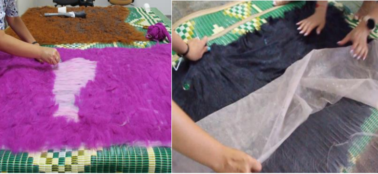
Şekil 15. Tasarım 3 için hazırlanan keçenin yün atıma ve keçeyi hazır rulodan ayırma aşaması
