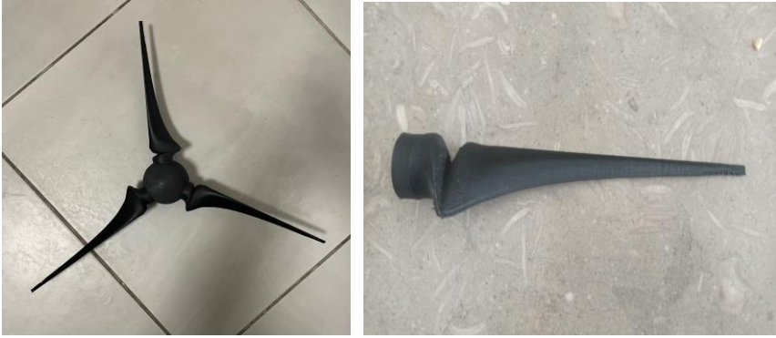
Şekil 13. Naca 4412 Kanat Profili Baskıları
