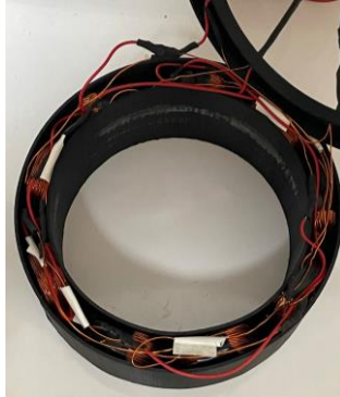
Şekil 16. Bobinlerin Bobin Yatağı İçine Yerleştirilmesi
