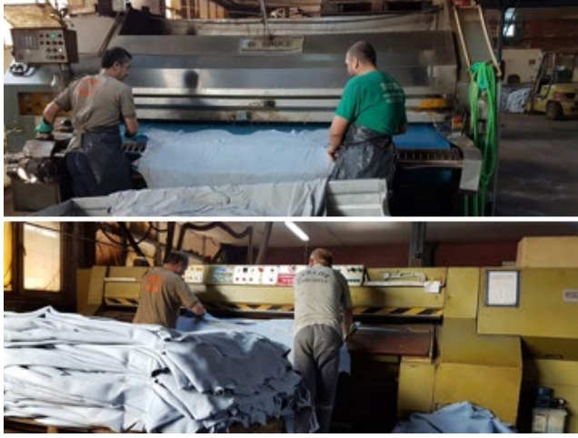
Şekil 3. Sıkma işlemi (üstte), Tıraş işlemi (altta)
