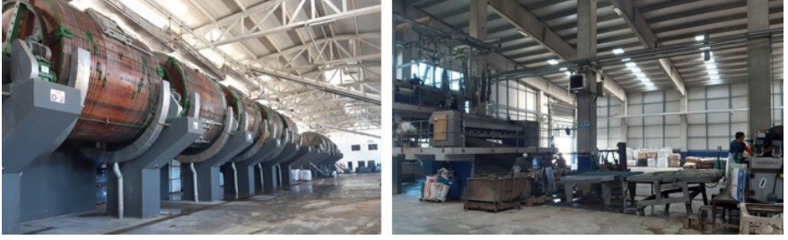
Şekil 2. Dolaplar (solda), Etleme ve Yarma Makinaları (sağda)
