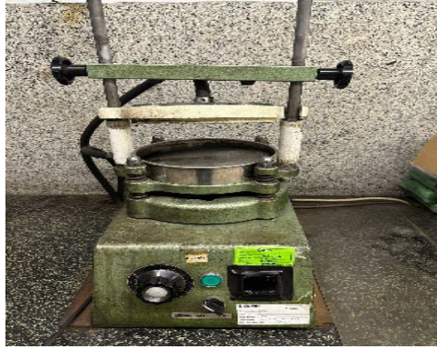
Şekil 4. Eleme İşleminde Kullanılan Titreşimli Eleme Makinesi Elenen ürünler sahip olduğu bilgilere göre sınıflandırılarak kullanıma hazırlanmış olur.
