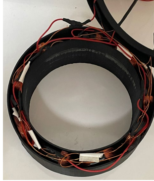
Şekil 16. Bobinlerin Bobin Yatağı İçine Yerleştirilmesi
