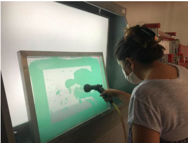
Resim-26: Pozlanan İpeğin Gözenekleri (Fotoğraf: Münüre Şahin)
