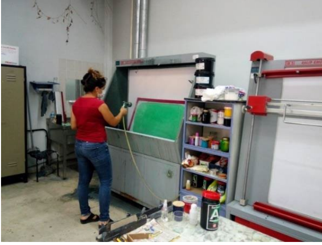
Resim-25: Pozlanan İpeğin Gözeneklerini Tazyikli Su ile Açma (Fotoğraf: Münüre Şahin)
